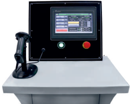
BARKOD OKUYUCU VE DOKUNMATİK EKRAN BARCODE SCANNER AND TOUCH SCREEN
