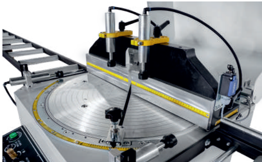
ÖNE ARKAYA HAREKETLİ SİPER FRONT-REAR MOVING GUARD
