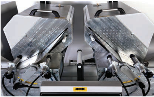
45° - 90° OTOMATİK KAFALAR 45° - 90° AUTOMATIC HEADS
